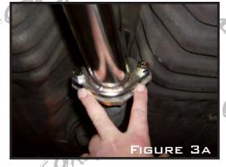
B. DOHC & SOHC: HEAD BACK UP TOP AND HANG THE MAIN HEADER OFF OF THE FACTORY EXHAUST STUDS. MAKE SURE YOU HAVE A GOOD GASKET UNDER IT. START 2 OF THE NUTS ONTO THE STUDS AND TIGHTEN THEM DOWN SNUG SO THE HEADER WON'T FALL OFF THE STUDS.
